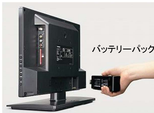
写真: バッテリー電源で停電時でも約3時間のテレビ視聴が可能な受信機 (出典: 東芝)
