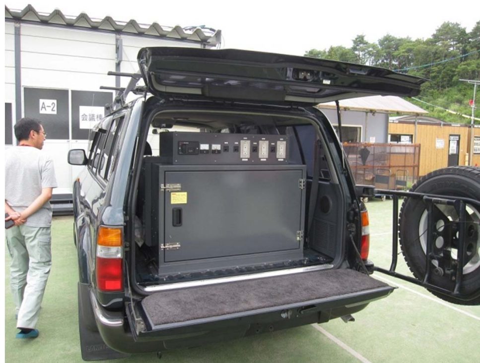
災害対策用移動電源車の配備
