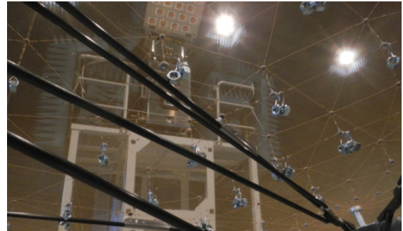
図 9 ボルトを吊るした状態
