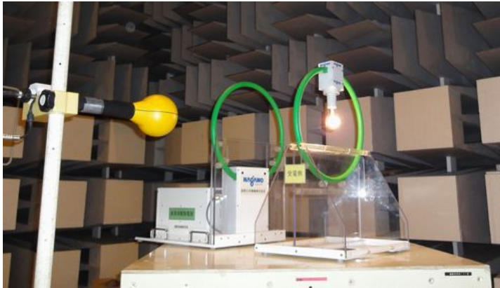
図4 ;磁界プローブ HF3061 による測定の様子
