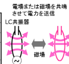
図 4 共鳴方式によるワイヤレス電力伝送
