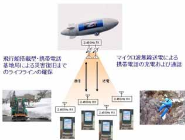
図9 将来の災害時の ad hoc な携帯電話基地局兼無線送電通話システム
